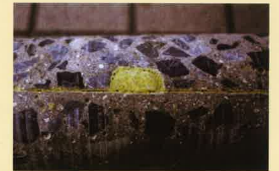
(2) 注入充填状況1: 打継ぎ部及びPWホースの周囲に良く充填されている。
